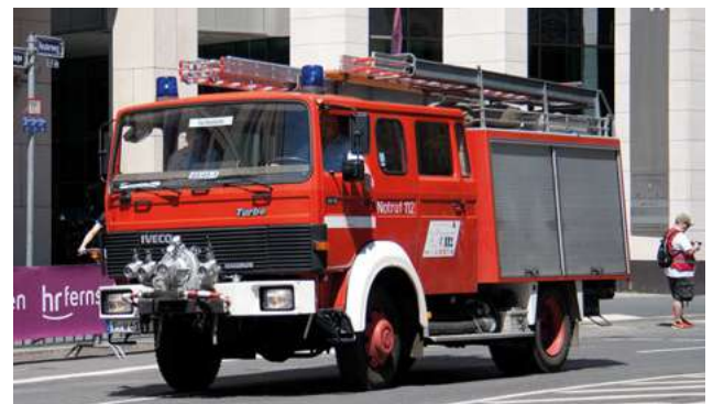
Löschgruppenfahrzeug LF 16 TS der FF Frankfurt-Fechenheim, Baujahr 1988, Iveco Magirus 90-16 AW, Aufbau Magirus
