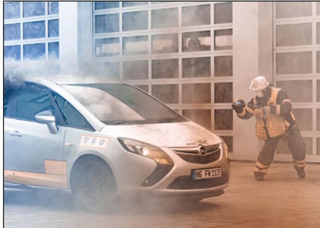
Der Fahrzeugführer kontrolliert im Rahmen seiner Erkundung das Fahrzeug. Eine Wärmebildkamera ermöglicht hier die thermische Kontrolle und, je nach Herangehen, die äußerlich grobe Temperaturermittlung des Hochvoltspeichers.
