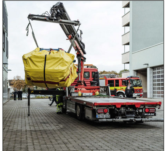
Das stehend havarierte Fahrzeug wird jeweils seitlich nacheinander angehoben und der Recover-E-Bag mittig bis zur vorderen Fahrzeugkontur untergezogen.
