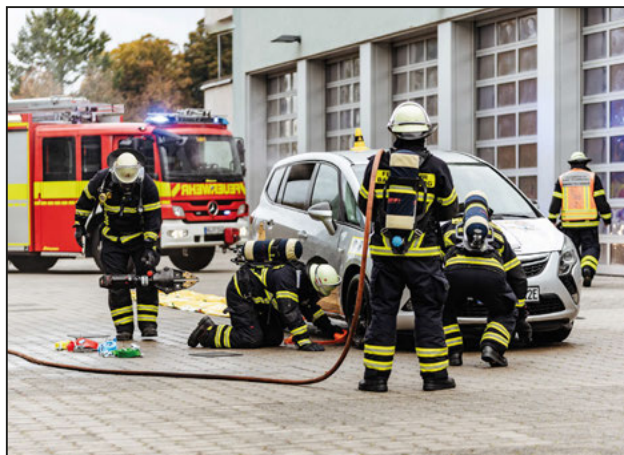
Ein bis zwei Trupps bringen den Recover-E-Bag in Stellung, ein Strahlrohr bleibt weiterhin in Bereitstellung. Der Kontakt mit der KFZ-Unterbodengruppe wird mittels Durchwerfen des orangenen Zurrgurtes verhindert.
