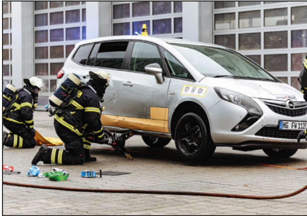
Das stehend havarierte Fahrzeug wird jeweils seitlich nacheinander angehoben und der Recover-E-Bag mittig bis zur vorderen Fahrzeugkontur untergezogen.
