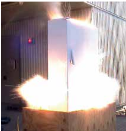
Berstschutzprüfung an einem Kabelverteilerschrank – dreiphasiger Lichtbogenkurzschluss mit etwa 10 kA im Inneren des Schrankes. Im Störlichtbogenfall treten nicht nur extrem hohe Lichtbogen-Ströme und Temperaturen auf, sondern auch extreme Druck- und Gasentwicklungen. Fotos: EBG, Lünen/Eurotest
