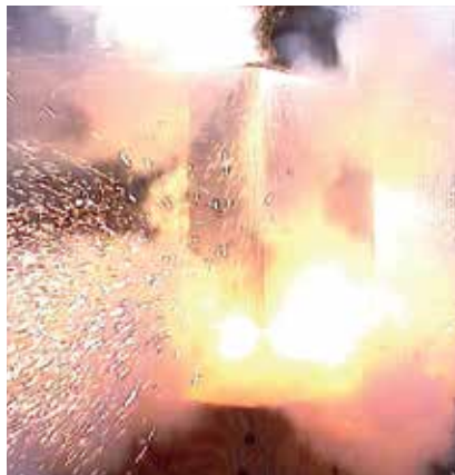
Berstschutzprüfung an einem Kabelverteilerschrank – dreiphasiger Lichtbogenkurzschluss mit etwa 10 kA im Inneren des Schrankes. Im Störlichtbogenfall treten nicht nur extrem hohe Lichtbogen-Ströme und Temperaturen auf, sondern auch extreme Druck- und Gasentwicklungen. Fotos: EBG, Lünen/Eurotest
