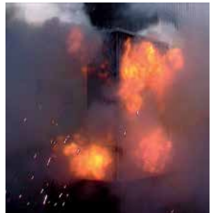
Berstschutzprüfung an einem Kabelverteilerschrank – dreiphasiger Lichtbogenkurzschluss mit etwa 10 kA im Inneren des Schrankes. Im Störlichtbogenfall treten nicht nur extrem hohe Lichtbogen-Ströme und Temperaturen auf, sondern auch extreme Druck- und Gasentwicklungen. Fotos: EBG, Lünen/Eurotest
