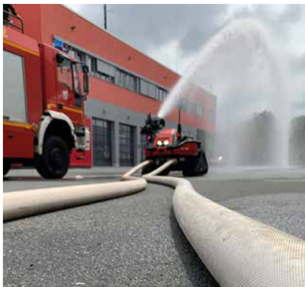
Schaum-Wasserwerfer des Magirus R1 (rd. 70 m Wurfweite)
