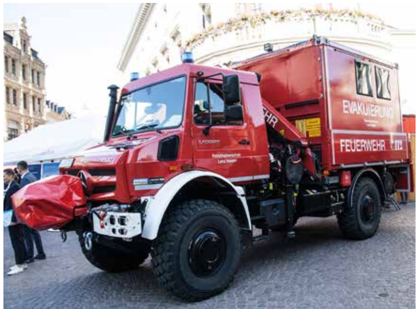
Hochgeländegängiger Unimog GW-L KatS mit Wechselaufbau »Evakuierung« Foto: Fenchel
