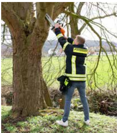
Nicht korrekt angelegte Schutz- ausrüstung und falscher Umgang mit den Gerätschaften
