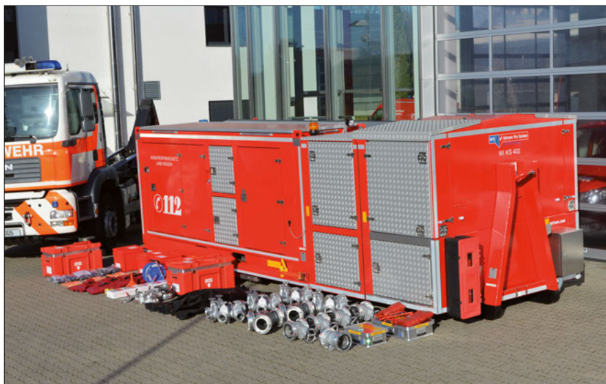
Abrollbehälter Löschwasser (AB-LWV) mit 1800 m F-Schlauch und 3000 l/min bei 11 bar Förderleistung (Bild: Matthias Schmidt)
